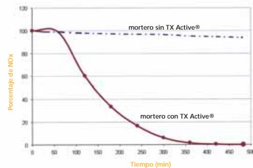
una cámara de volumen conocido en la que se insufla NO<sub>2</sub> que, diluido con el aire contenido, alcanza una concentración contaminante predefinida.
